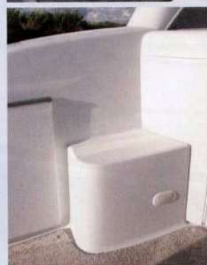
A lato, per agevolare l'accesso al passavanti sinistro è stato sistemato un gradino a ridosso della murata.
